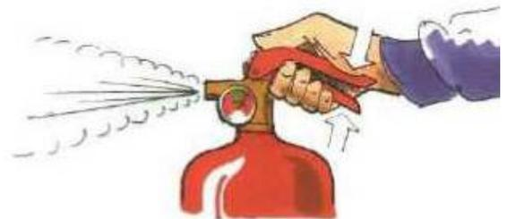
Azionare l'estintore alla **giusta distanza dalla fiamma** per colpire il focolare con la massima efficacia del getto, compatibilmente con l'intensità del calore.
